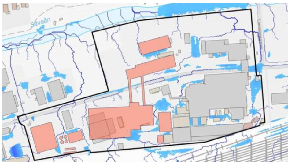
Figur 18. Skyfallsanalys av planerad situation i Scalgo Live. Planerade huskroppar markerade med rött. (Structor Mark, 2025).
