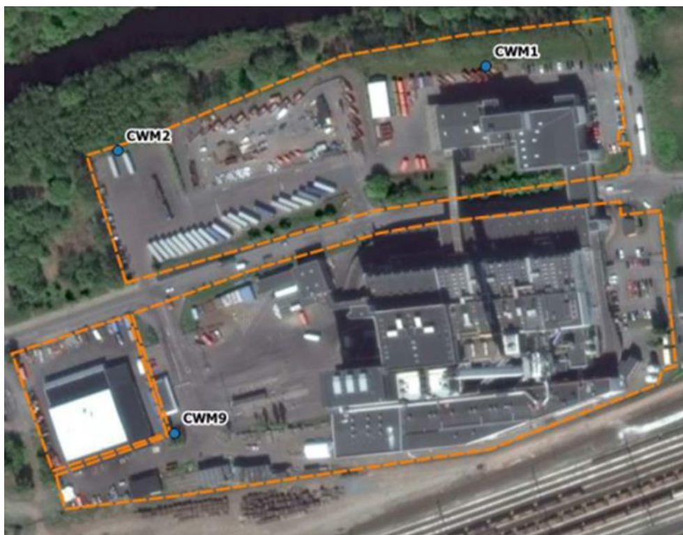
Figur 12. Översikt över installerade grundvattenrör. Orange streckad linje anger ungefärlig fastighetsgräns för fastigheterna Sävenäs 168:2 och Sävenäs 168:5. Figur från COWI, 2018.
